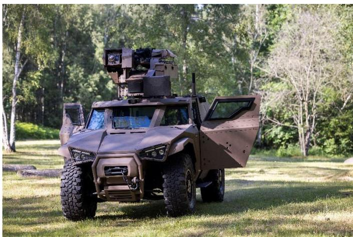
Le SCARABEE vise à proposer des solutions innovantes pour le remplacement du VBL (*Véhicule Blindé Léger*), dans le cadre du programme VBAE (*Véhicule Blindé d'Aide à l'Engagement*). Ce démonstrateur de 8 tonnes pouvant atteindre les 120 km/h a bénéficié des innovations portées par Arquus et soutenues par la DGA dans plusieurs domaines sensibles.
