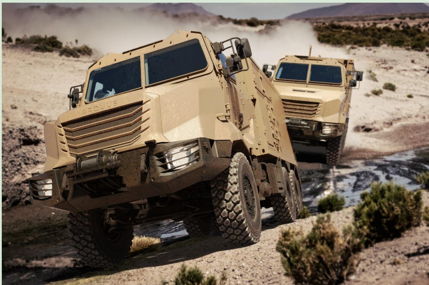
Modulaires, ils peuvent prendre en charge de nombreuses configurations, assurant efficacité, simplicité d'utilisation et liberté tactique pour le commandant sur le terrain. En fonction des missions, ils peuvent être équipés d'une cabine non protégée, ou protégée balistique et mines en conformité avec le STANAG 4569. Evolutifs dans le temps, ils sont en mesure de s'adapter au mieux aux besoins opérationnels et aux menaces rencontrées sur le champ de bataille.
