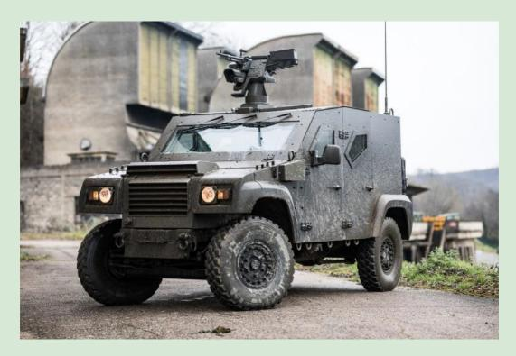
Les protections balistique, anti-mine et anti-IED du Dagger sont aux normes STANAG 4569.
